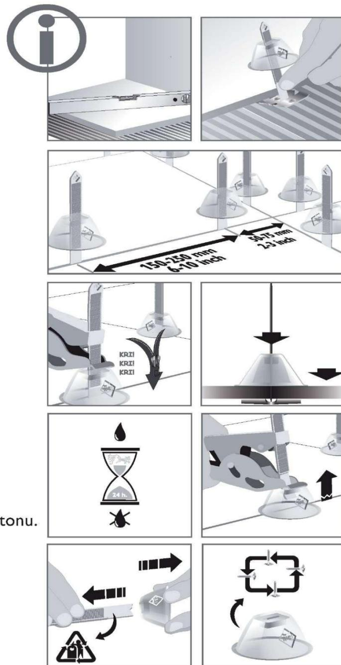
Fakticky eliminuje nerovnosti dlažby během procesu tvrdnutí lepidla nebo betonu. Konstruován pro rychlé položení žulových a mramorových obkladů v rovině bez nutnosti použití doplňujících přípravků.
