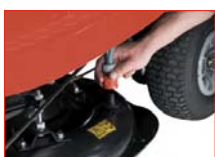
Přípojka na vodu pro rychlé čištění žacího ústrojí.
