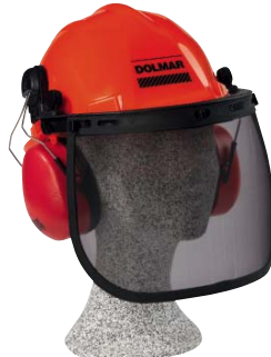
Ochranná přilba DOLMAR Safety pro příležitostné, soukromé použití, je-li zapotřebí úplného ochranného vybavení pro práci s motorovou pilou. Standardní, plastový štít, hustota ok 1 x 1 mm, ochrana sluchu standardní, SNR 23 dB(A). 988.000.005
