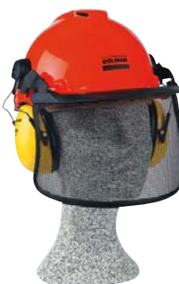
Ochranná přilba G22d, atest KWF = FPA, kovový štít V4c se sluneční clonou, hustota ok 1,8 x 2,5 mm, nerezová ocelová síťka s propustností světla 75 %, s ochranou sluchu H510P3e, SNR 26 dB(A). 988.000.012
